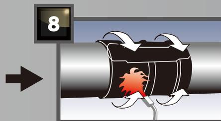
加熱先由防蝕套中央開始並向兩端螺旋式移動。
