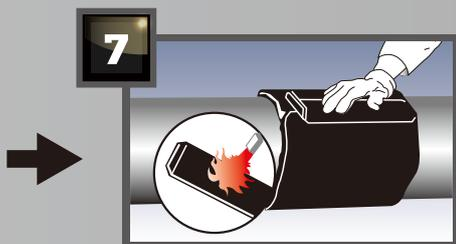
加熱固定片使其完全黏覆於防蝕套兩端重疊處，重疊至少100mm且底部與管面縫隙預留約25mm以利加熱收縮。
